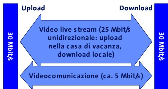
Per la soluzione di comunicazione video mostrata viene utilizzata una webcam con una risoluzione in qualità SD. Le immagini e i suoni vengono sincronizzati mediante il ritardo del suono. Il live stream viene realizzato con una videocamera di rete da 1600x1200 pixel (24 immagini/s) che soddisfa la specifica HD-720.
