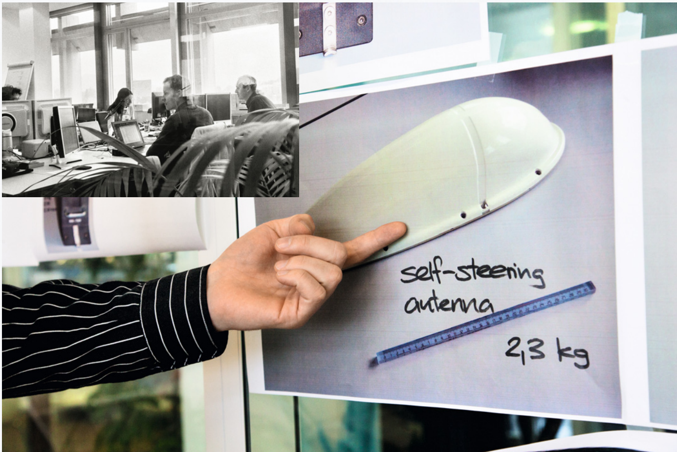
Hier wird die Kommunikationslösung für SOLAR IMPULSE entwickelt. Ein Team von Ingenieuren leistet Pionierarbeit. Das Gerät muss wahre Wunder vollbringen: Es ermöglicht Videokonferenzen, es sendet Positions- und Sensordaten, Wetterdaten, Filme aus dem Cockpit, den Pulsschlag des Piloten und vieles mehr. Im Moment ist gerade die Antenne das Thema.
