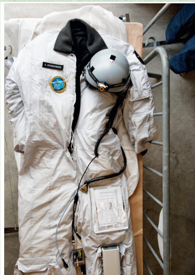
Das Flugzeug hat kein Heiz- oder Kühlsystem, deshalb braucht der Pilot einen THERMOANZUG , der die extremen Temperaturen zwischen +40 GRAD und -20 GRAD im Cockpit ausgleicht, indem er auf Knopfdruck des Piloten an- und abschwillt.
