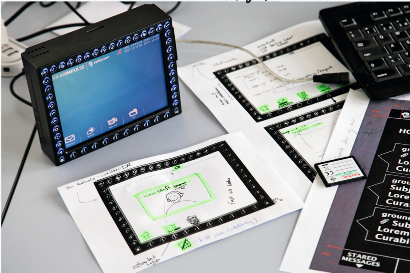
Hier wird die Kommunikationslösung für SOLAR IMPULSE entwickelt. Ein Team von Ingenieuren leistet Pionierarbeit. Das Gerät muss wahre Wunder vollbringen: Es ermöglicht Videokonferenzen, es sendet Positions- und Sensordaten, Wetterdaten, Filme aus dem Cockpit, den Pulsschlag des Piloten und vieles mehr. Im Moment ist gerade die Antenne das Thema.
