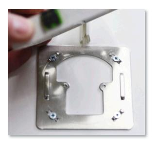
Infine, nel rimontare la presa occorre sentire il clic d'incastro della presa. A tal fine verificare che il cavo della fibra ottica non sia incastrato nel canale del cavo. Poi collocare l'ID della presa nuovamente al proprio posto.
