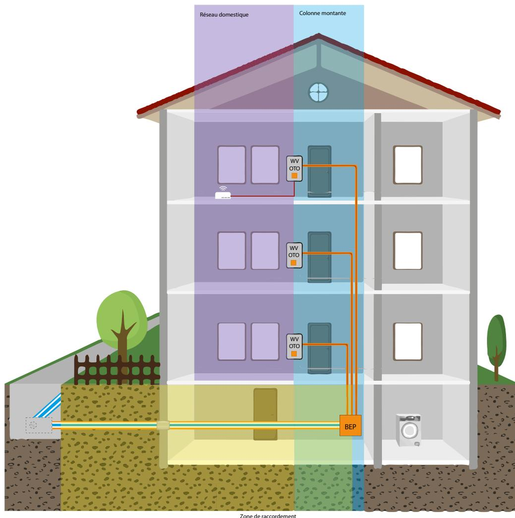
Figure 5: exemple d'immeuble collectif équipé de conduites en étoile dans la colonne montante.
