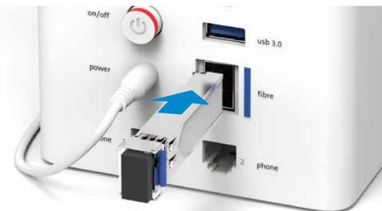
Insérez le module fibre optique dans le port «fibre» jusqu'à ce qu'il s'encastre. Les marquages en bleu sur le module fibre optique (étrier) et l'Internet-Box figurent du même côté.
