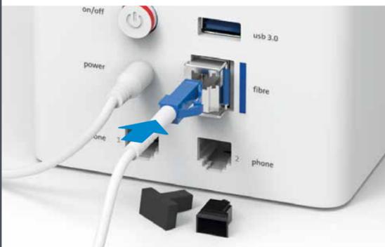
Retirez les embouts de protection et raccordez l'extrémité bleue du câble à l'Internet-Box.
