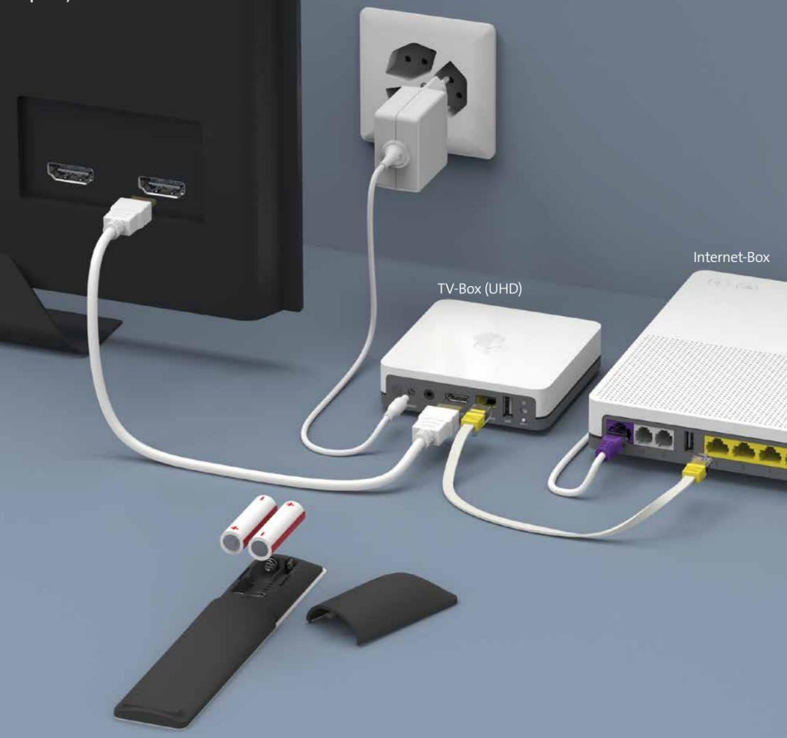
**4** Raccordez la TV-Box au téléviseur avec le nouveau câble HDMI.
