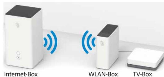
Installi il Swisscom WLAN-Box wireless secondo le relative istruzioni e colleghi il TV-Box al WLAN-Box tramite il cavo Ethernet in dotazione.
