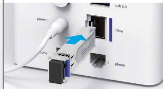
Insérez le module fibre optique dans le port «fibre» jusqu'à ce qu'il s'encastre. Les marquages en bleu sur le module fibre optique (étrier) et l'Internet-Box figurent du même
