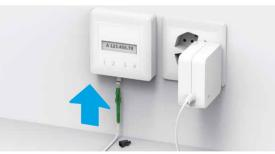
Pour la prise de fibre optique, utilisez l'emplacement que nous vous avons indiqué dans le courrier. Il s'agit en règle générale du port 2, et rarement du 1. Retirez l'embout de protection et raccordez l'extrémité **verte** du câble.
