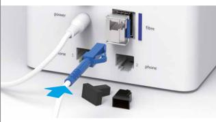
Retirez les embouts de protection et raccordez l'extrémité bleue du câble à l'Internet-Box.
