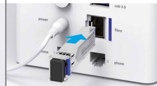
Inserire il modulo per fibra ottica nello slot «fibre» fino a quando scatta. I contrassegni blu sul modulo per fibra ottica (levetta) e su l'Internet-Box devono trovarsi sullo
