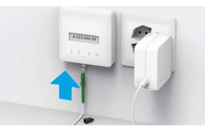
Sulla presa per fibra ottica, aprire lo slot indicato nella lettera. Normalmente si tratta dello slot 2, in rari casi dello slot 1. Rimuovere la protezione e collegare l'estremità **verde**
